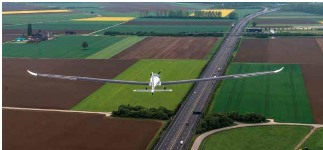
Les ailes de l'avion solaire mesurent 25 mètres d'envergure et sont équipées de 22 m<sup>2</sup> de cellules photovoltaïques. • Photo: Révillard/Rezo/SolarStratos
