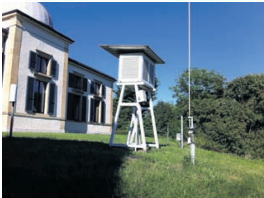
Station météorologique en place à l'Observatoire de Neuchâtel depuis 1864. Actuellement, les principales données météo (température, ensoleillement, précipitation, etc.) sont enregistrées automatiquement toutes les 10 minutes. • Photo: sp
