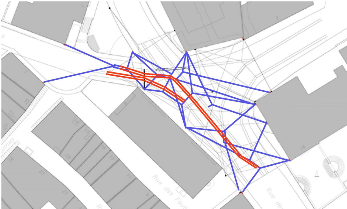
2 - Présentation de la complexité de l'intervention pour la jonction de la ligne de contact entre la rue des Terreaux et la rue des Bercles.
