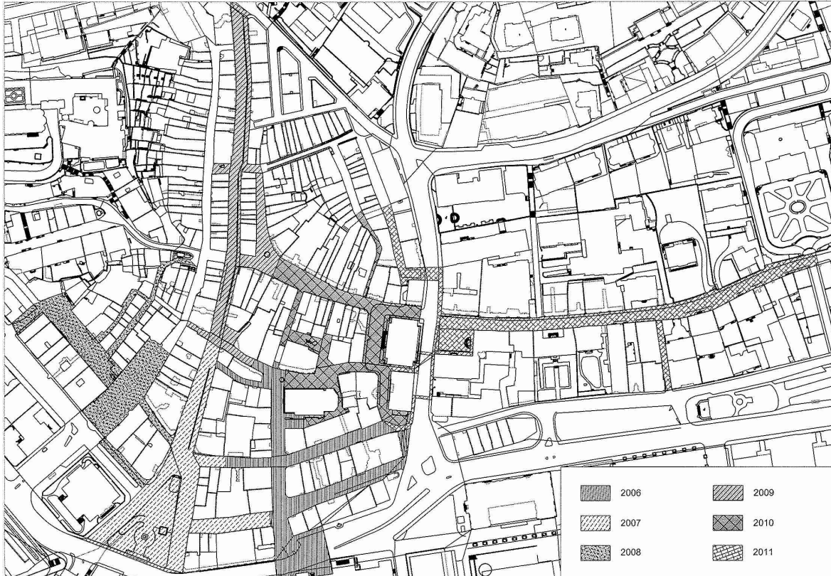
Figure 6 : étape de travaux des équipements souterrains dans la zone piétonne 2006 – 2011
