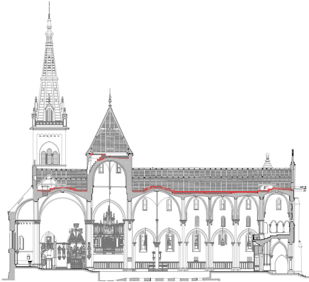
Figure 19. En rouge, l'isolation thermique qui sera posée
