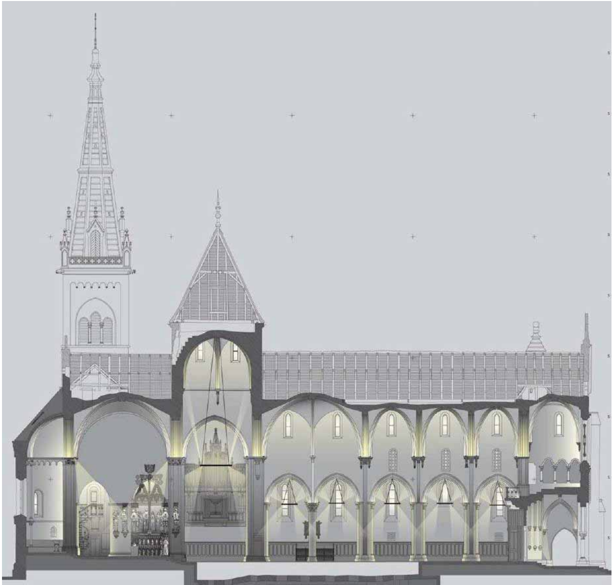
Figure 25. Principe de mise en lumière. Illustration des lustres-supports
